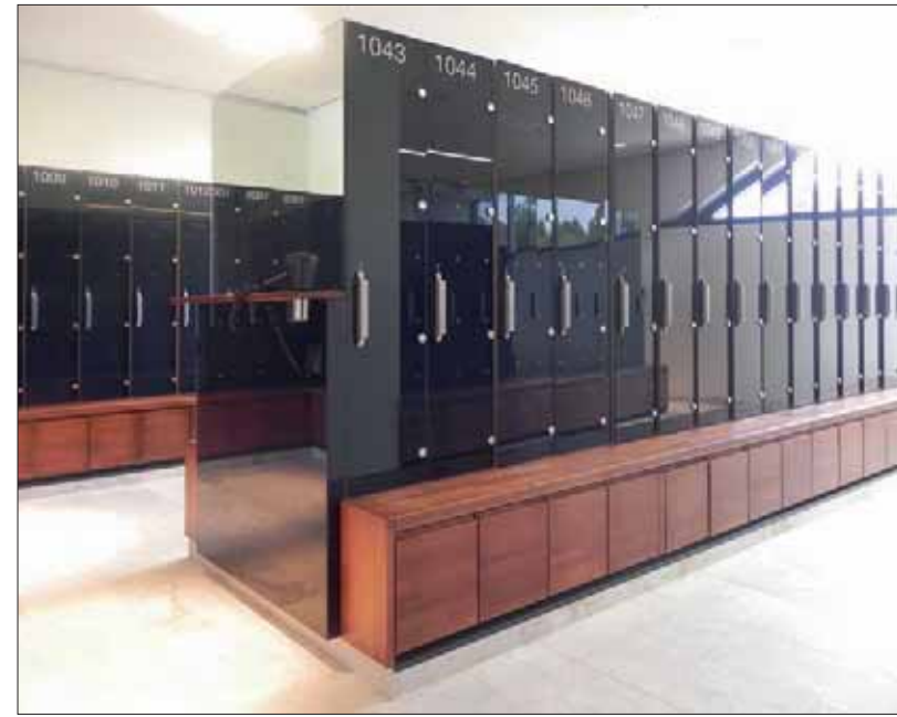
TSG-6/I / 300 mm breit / Sitzbank Buche massiv, Beize Nuss / mit Schublade Vollauszug / Ganter Online Schloss Typ GAT Lock 5010B / Edelstahlgriff / Rückwandentlüftung / Folienbeschriftung / Korpus RAL 1013 / Glasüren und Glasverblenden RAL 7016
