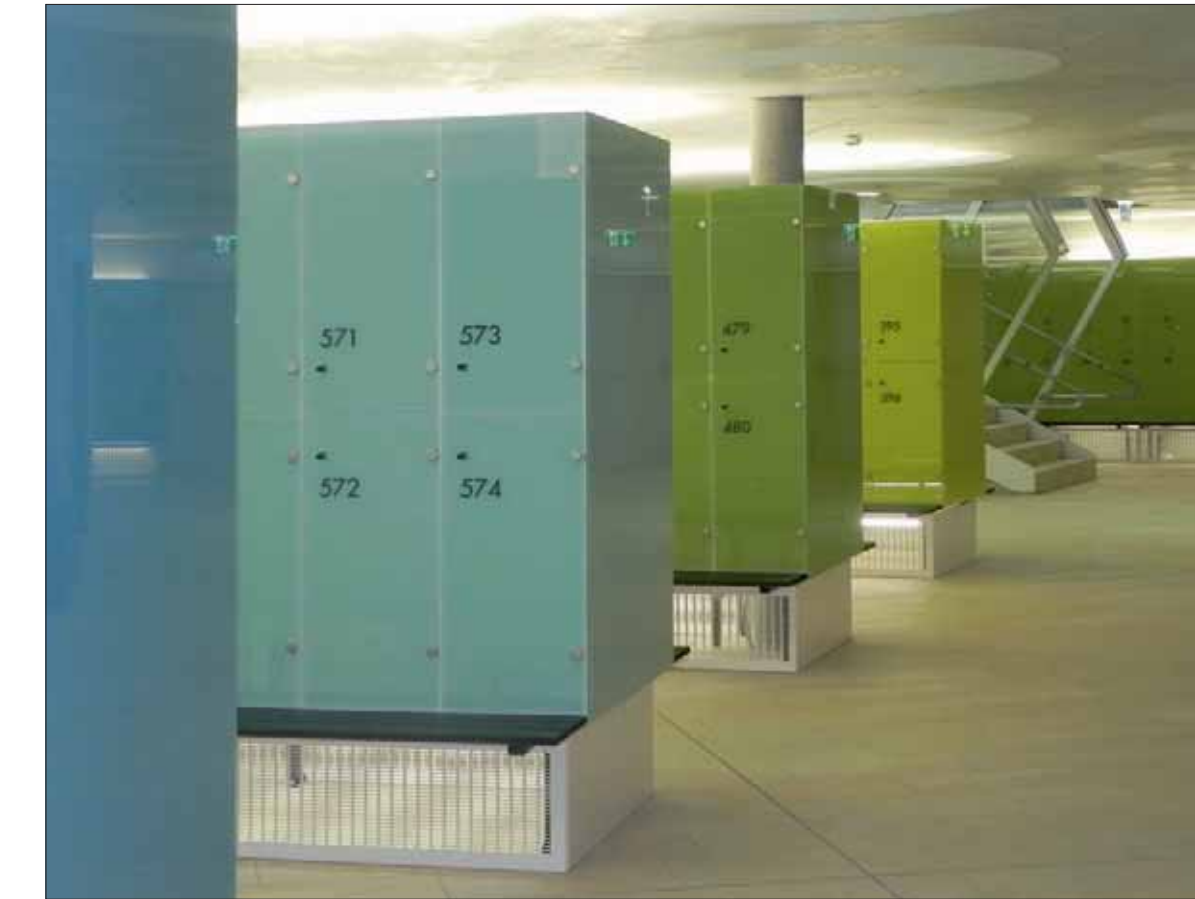
TSG-6/2 / 400 mm breit / Kötschacher Sitzbank, Untergestell verblendet / abnehmbare Blechverblendung vollporiert / Buche massiv, schwarz gebeizt / elektronisches Batterieschloss Typ Häfelle / Rückwandentlüftung / Folienbeschriftung / Korpus RAL 9001 / Glasüren und Glasverblenden NCS-S-1050-G40Y + NCS-S-0560-G40Y + NCS-S-1030-B70G + NCS-S-1040-B40G
