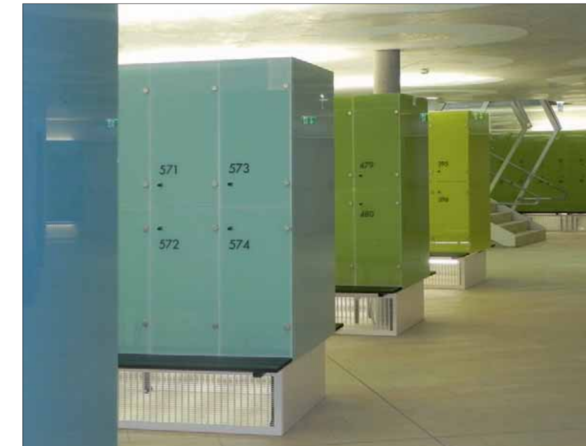
TSG-6/2 / 400 mm breit / Kötschacher Sitzbank, Untergestell verblendet / abnehmbare Blechverblendung vollporiert / Buche massiv, schwarz gebeizt / elektronisches Batterieschloss Typ Häfelle / Rückwandentlüftung / Folienbeschriftung / Korpus RAL 9001 / Glasüren und Glasverblenden NCS-S-1050-G40Y + NCS-S-0560-G40Y + NCS-S-1030-B70G + NCS-S-1040-B40G
