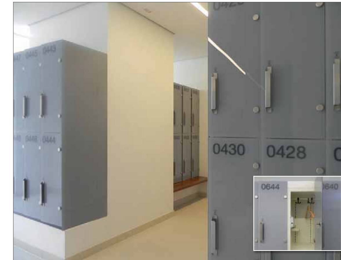
TSG-6/2 / 400 mm breit / bauseits Sockel Beton / Ganter Online Schloss Typ GAT Lock 5010B / Edelstahlgriff / Rückwandentlüftung / Folienbeschriftung / Korpus RAL 1013 / Glasüren und Glasverblenden NCS 3010-B
