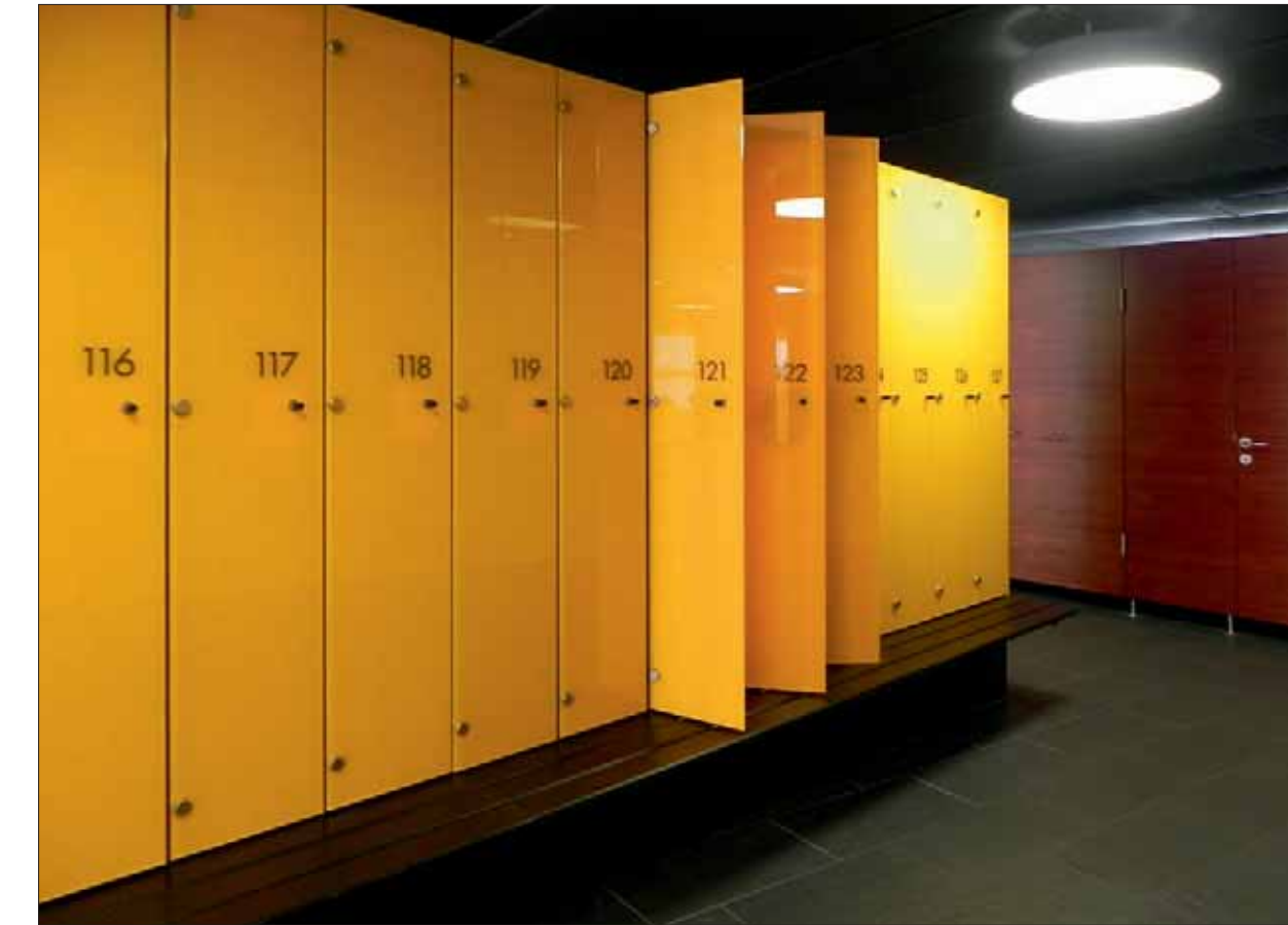
TSG-6/I / 300 mm breit / Kötschacher Sitzbank, Untergestell verblendet / abnehmbare Blechverblendung vollporiert / Buche massiv, schwarz gebeizt / elektronisches Batterieschloss Typ Häfelle / Rückwandentlüftung / Folienbeschriftung / Korpus RAL 7016 / Glasüren und Glasverblenden RAL 1003
