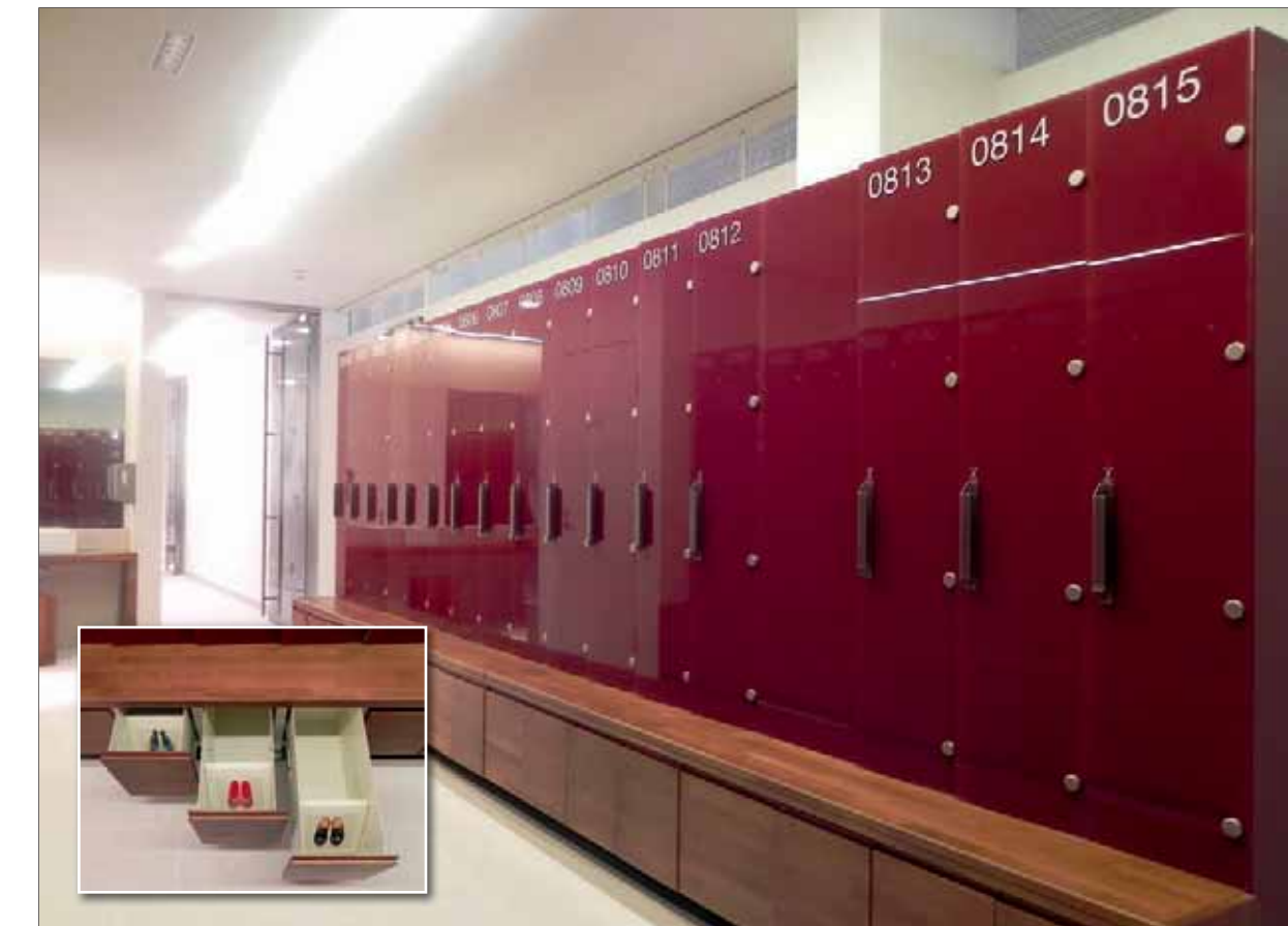
TSG-6/1 / 300 mm breit / Sitzbank Buche massiv, Beize Nuss / mit Schublade Vollauszug / Ganter Online Schloss Typ GAT Lock 5010B / Edelstahlgriff / Rückwandentlüftung / Folienbeschriftung / Korpus RAL 1013 / Glasüren und Glasverblenden RAL 3004 - Detailbild: Schuhfach mit Piktogramm, sperrbar über Schranktür mit Hubmagnet
