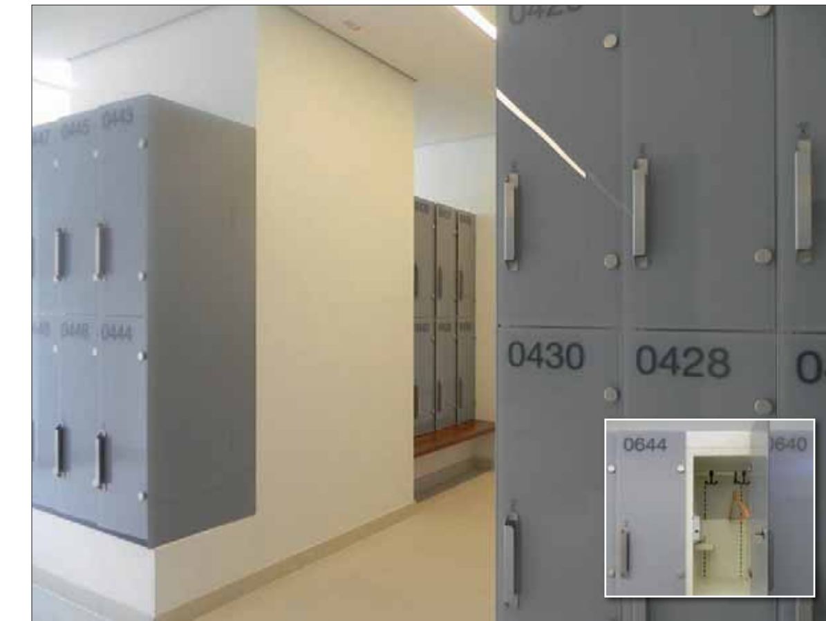
TSG-6/2 / 400 mm breit / bauseits Sockel Beton / Ganter Online Schloss Typ GAT Lock 5010B / Edelstahlgriff / Rückwandentlüftung / Folienbeschriftung / Korpus RAL 1013 / Glasüren und Glasverblenden NCS 3010-B
