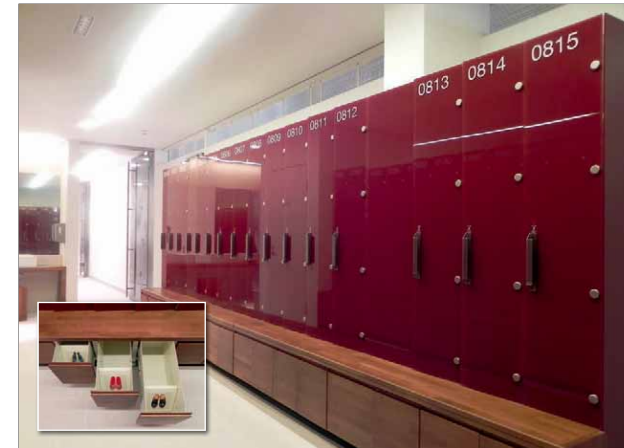
TSG-6/I / 300 mm breit / Sitzbank Buche massiv, Beize Nuss / mit Schublade Vollauszug / Ganter Online Schloss Typ GAT Lock 5010B / Edelstahlgriff / Rückwandentlüftung / Folienbeschriftung / Korpus RAL 1013 / Glasüren und Glasverblenden RAL 3004 - Detailbild: Schuhfach mit Piktogramm, sperrbar über Schranktür mit Hubmagnet
