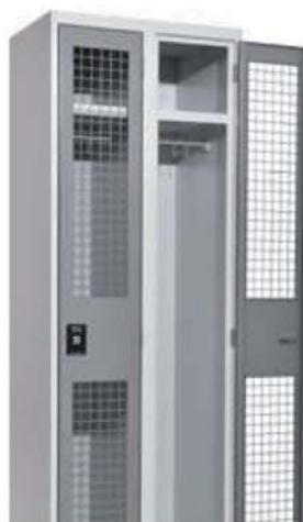
**Gittertür** aus 1,5 mm starkem Stahlblech einschlagend mit eingeschweißtem Gitter 3 mm stark, Maschenweite 30 x 30 mm, 180° öffnend durch sichtbare Kegelbänder
