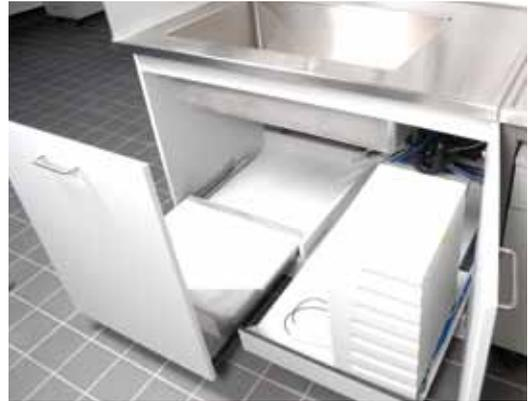
Unterschrank für ausziehbare Reinstwasseranlage
