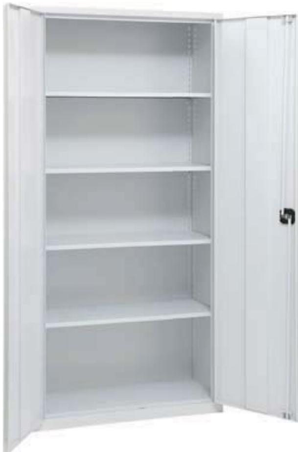
**Korpus:** Konstruktion aus elektrolytisch verzinktem Stahlblech 0,75 mm stark. Durch spezielle Umbüge der Holme, Seitenwände und Rückwand sowie punktverweißte Verbindungen wird eine hohe Stabilität erreicht. Die 20 mm negativ eingebaute Rückwand gewährt eine zusätzliche Steifigkeit und hemmt eventuelle Schimmelbildung hinter dem Schrank.
